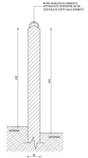
DETTAGLIO MURO ESISTENTE SCALA 1:20
