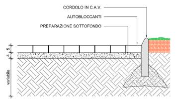
DETTAGLIO PAVIMENTO ESTERNO SCALA 1:10
